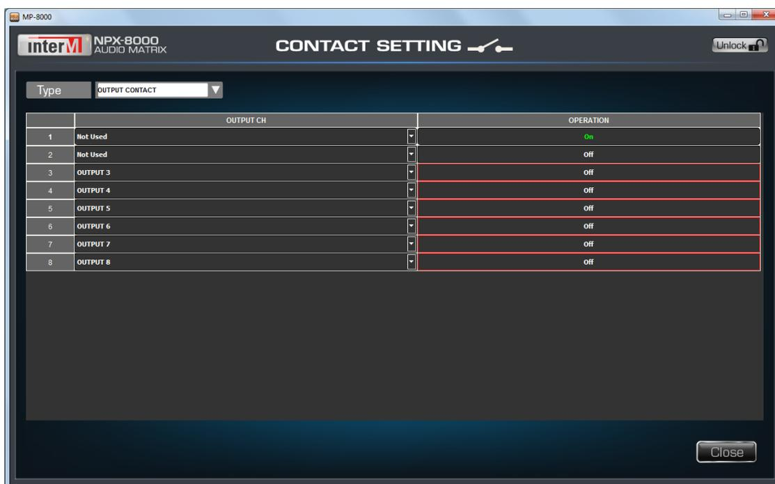
Использование выходного «сухого» контакта в автоматическом режиме подразумевает автоматическое замыкание контакта при появлении звукового сигнала на одном из звуковых выходов и размыкание контакта при пропадании сигнала. Для использования выходного «сухого» контакта в данном режиме в столбце OUTPUT CH напротив номера контакта нужно выбрать номер выходного канала.
