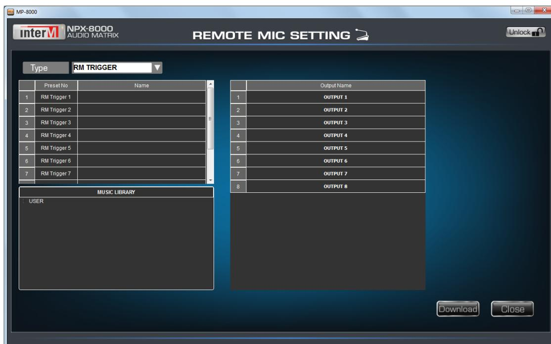
Для настройки функции RM Trigger нужно выделить нужный номер события в столбце Preset No, далее в списке MUSIC LIBRARY выбирается один из звуковых файлов, расположенных на SD-карте NPX-8000. В таблице справа выбираются выходные каналы, в которые будет транслироваться звуковой файл при запуске RM Trigger.
