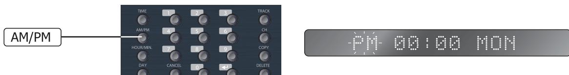
3) Нажмите кнопку HOUR/MIN, при этом на дисплее начнут мигать цифры, соответствующие часам. С помощью кнопок 0—9 установите текущее время.
