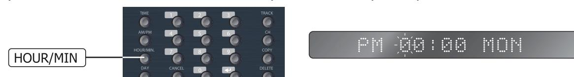
4) Нажмите кнопку HOUR/MIN еще раз. При этом на дисплее начнут мигать цифры, соответствующие минутам. С помощью кнопок 0—9 установите текущее время.
