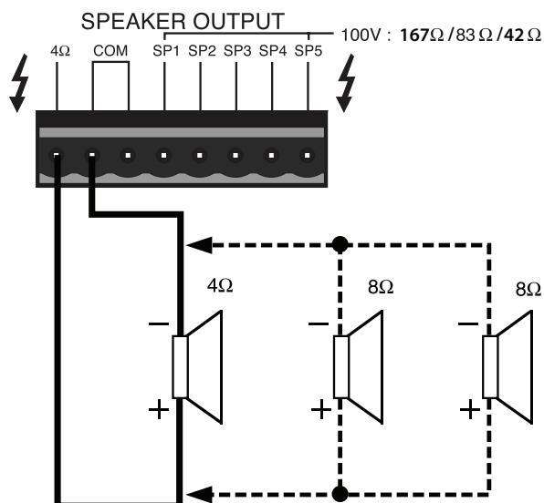
При использовании трансляционных громкоговорителей соблюдайте полярность. 100 В линия формируется с помощью выходного согласующего трансформатора.
