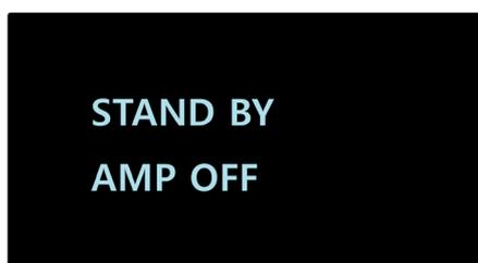
Данное сообщение означает, что кабель питания подключен, кнопка включения находится в выключенном положении, а загрузка системы успешно завершена. Включение кнопки питания когда система показывает данное сообщение переводит усилитель в активный режим, после чего отображается экран контроля каналов.
