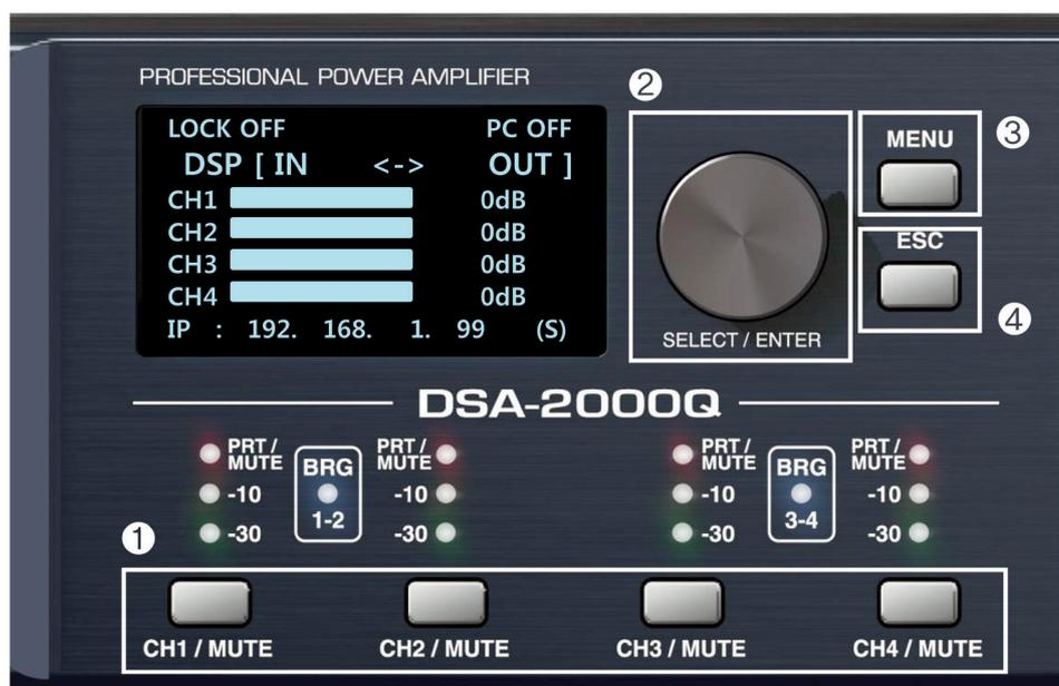
Приведенный выше экран появляется когда подано напряжение питания, завершена загрузка системы, кнопка включения находится в положении ВКЛЮЧЕНО. На экране отображается уровень громкости входного или выходного канала и IP-адрес каждого усилителя, также здесь вы можете проверить статус соединения с компьютером (PC ON/OFF).
