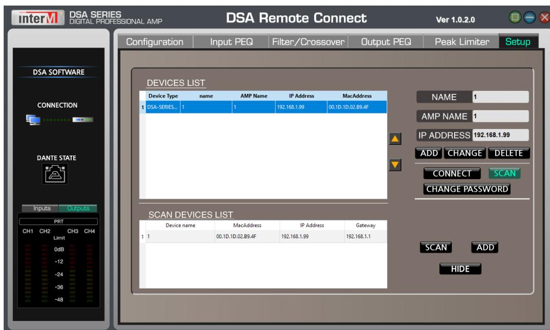
Откройте приложение и нажмите на вкладку SETUP в верхней панели навигации. В открывшемся окне нажмите на кнопку SCAN, чтобы программа произвела поиск устройств в сети.
