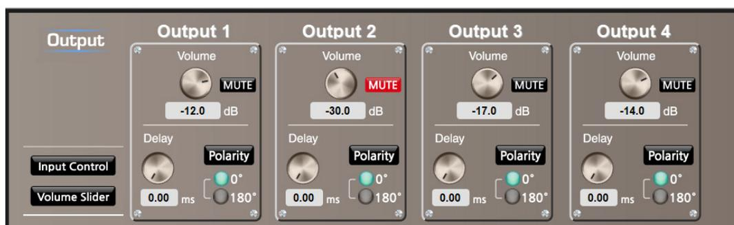
Для перехода в зону управления громкостью, задержкой и полярностью выходных каналов нажмите на кнопку Input Control или иконку Delay подраздела Output. Регулировка громкости доступна в диапазоне от -50 дБ до 0 дБ, кнопка Mute отключает звук канала, Delay позволяет регулировать время задержки сигнала до 340 мс, кнопка Polarity позволяет развернуть фазу сигнала на 180°.
