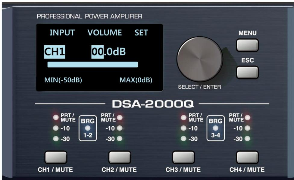
При нажатии на кнопку CH/MUTE во время отображения экрана инициализации вы попадете в раздел управления громкостью соответствующего канала.
