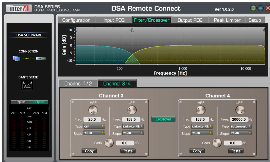
В режиме Vi-Amp настройки выходного параметрического эквалайзера, задержки и лимитера остаются несвязанными.
