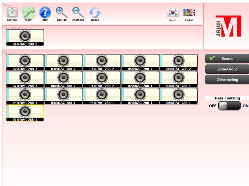
Управление аудиопотоками осуществляется во вкладке «Control» путем выбора передающих каналов в области «Registered Source» и принимающих в области «Control» и нажатием кнопки «Subs on».
