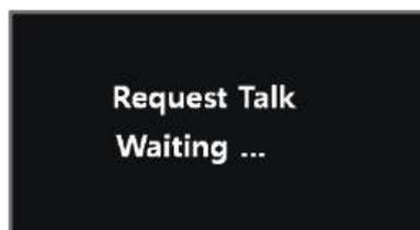
Если RM-N3000 не зарегистрирована в качестве источника сигнала в интерфейсе программы MS-N300, данная заставка появится на 10 секунд, а затем панель вернется в состояние STANDBY.
