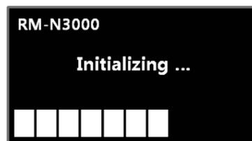
По окончании загрузки панель перейдет в режим ожидания (STANDBY). Если устройство подключено к сети, на экране появится его IP-адрес (заводское значение 192.168.1.99).
