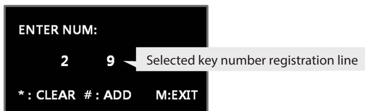
Если требуется удалить введенную ранее зону трансляции, нужно еще раз повторить процедуру введения данной зоны (функция Remove):
