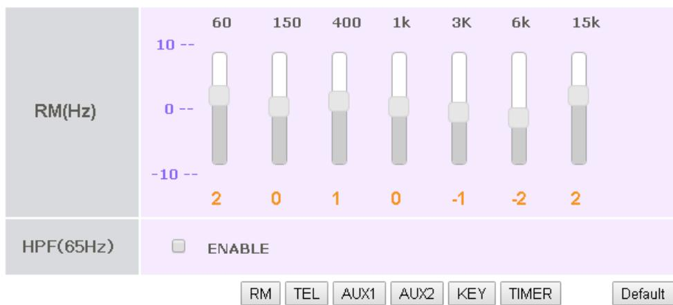
Для каждого типа включения входных сигналов можно настроить свой уровень АЧХ. Чтобы настроить уровень сигналов каждого из источников:
