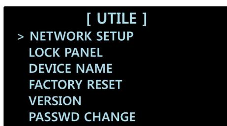
В разделе UTILITY SETTINGS представлены: настройка сети (NETWORK SETUP), блокировка органов управления (LOCK PANEL), название устройства (DEVICE NAME), сброс до заводских настроек (FACTORY RESET), версия прошивки (VERSION) и смена пароля (PASSWD CHANGE).
