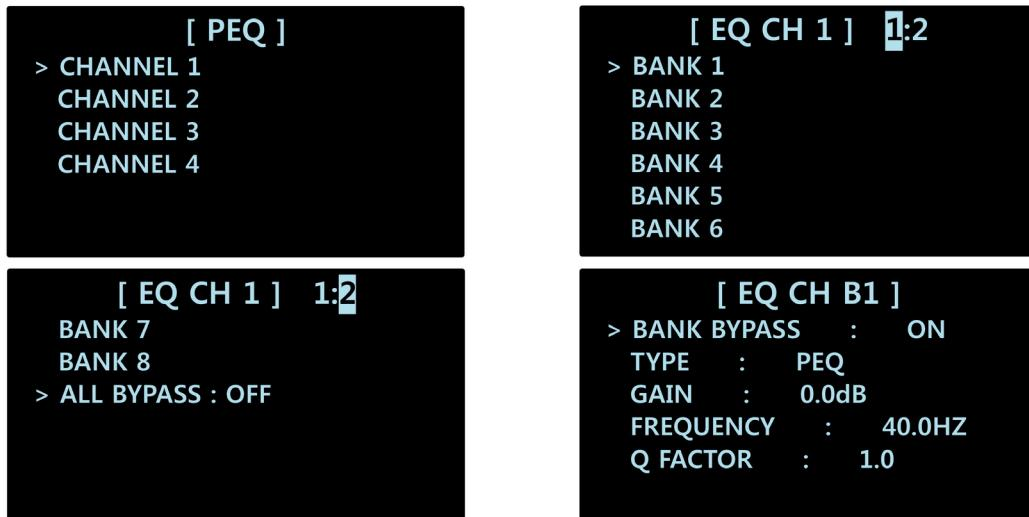
Параметры эквалайзера устанавливаются индивидуально для каждого канала.
