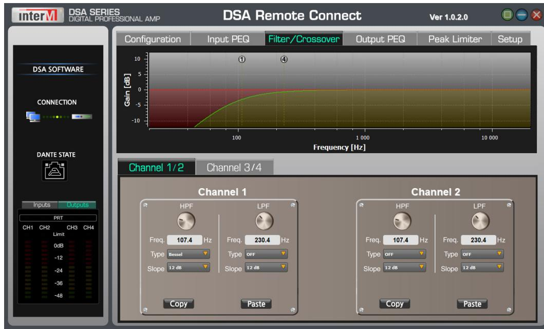
Для входа в настройки частотных фильтров и кроссовера, нажмите на вкладку Filter/Crossover. В верхней части окна отображаются полосы частот сразу для двух каналов.
