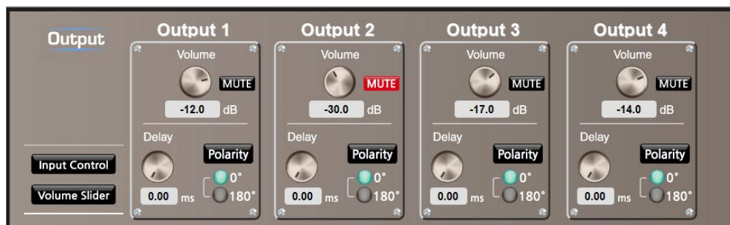
Для перехода в зону управления громкостью, задержкой и полярностью выходных каналов нажмите на кнопку Input Control или иконку Delay подраздела Output.
