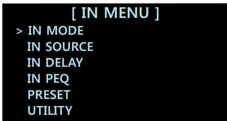
В меню входов представлены несколько пунктов, включающие IN MODE (режим работы входов), IN SOURCE (источник сигнала), IN DELAY (задержка на входе), IN PEQ (параметрический эквалайзер), а также PRESET (предустановки) и UTILITY (утилиты). PRESET и UTILITY также доступны в OUT MENU.
