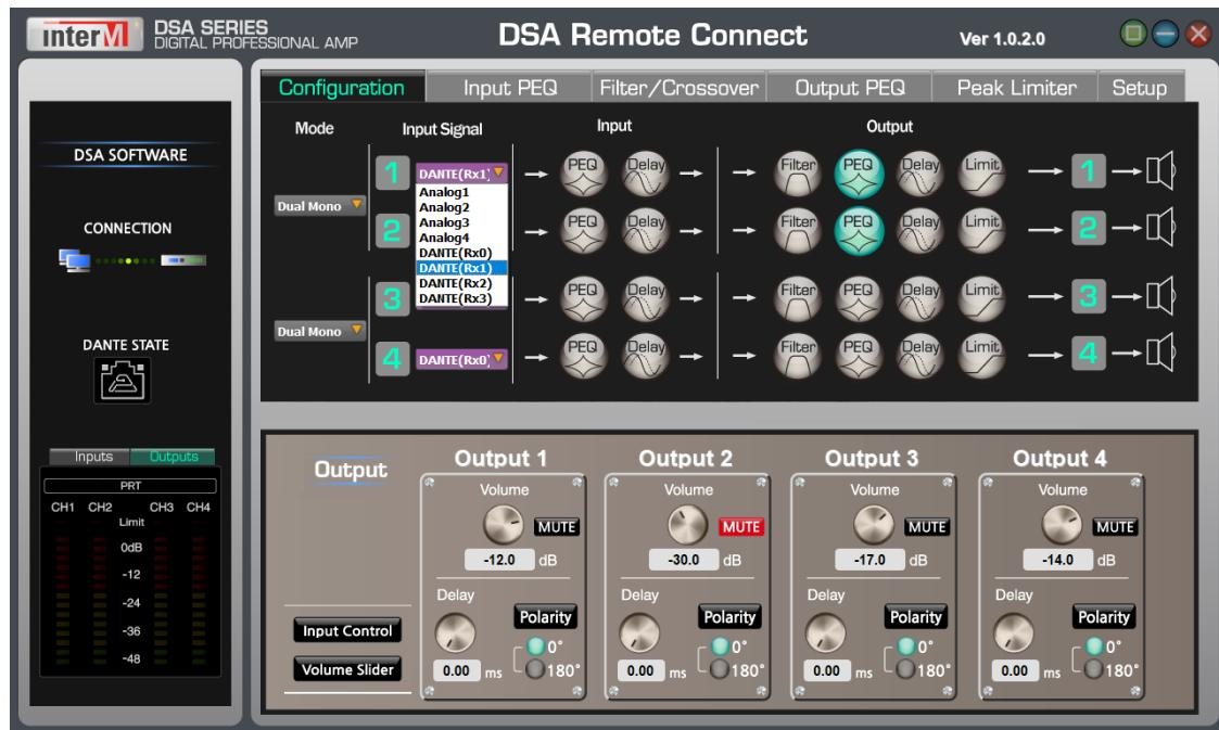
Чтобы сконфигурировать каналы усилителя войдите во вкладку Configuration. В верхней части окна доступны настройки режима работы пары каналов MODE, настройки источников сигнала для каждого канала Input Signal, включение модулей обработки сигнала PEQ, Delay для входных каналов INPUT и включение модулей обработки сигнала Filter, PEQ, Delay, Limit для выходных каналов Output.
