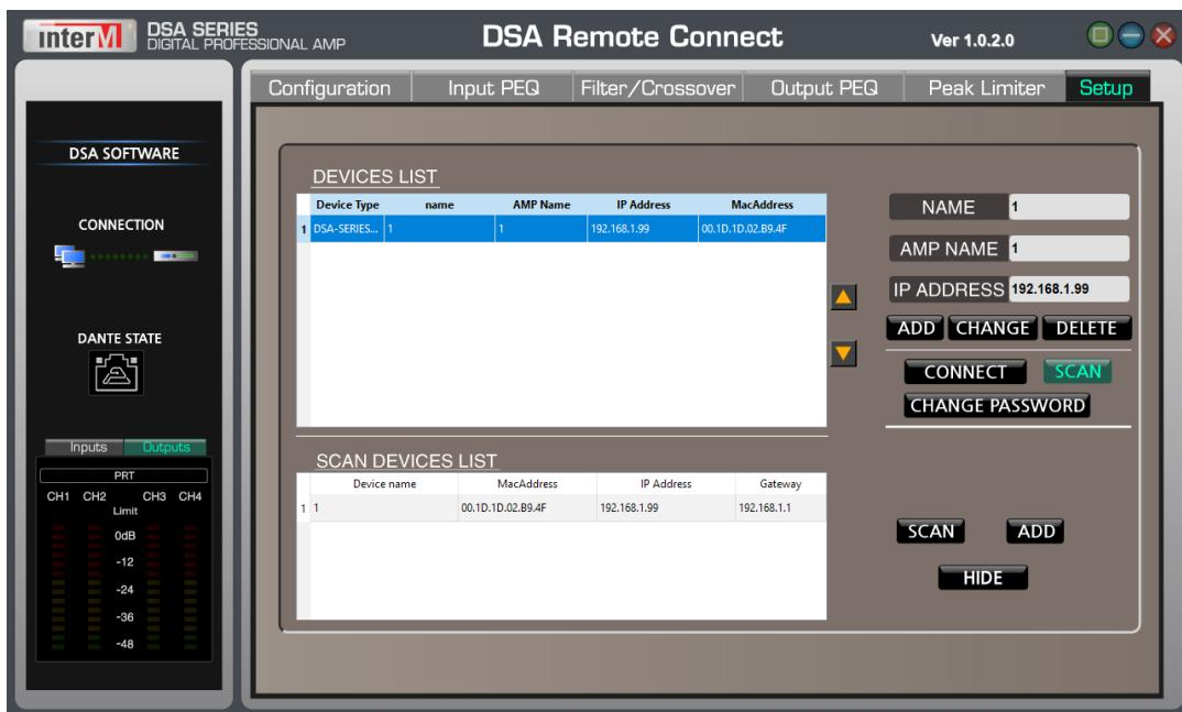
Откройте приложение и нажмите на вкладку SETUP в верхней панели навигации. В открывшемся окне нажмите на кнопку SCAN, чтобы программа произвела поиск устройств в сети. В окне SCAN DEVICE LIST отобразится список всех доступных усилителей серии DSA. Выделите нужное устройство в списке и нажмите на кнопку ADD, чтобы добавить усилитель в перечень управляемых устройств DEVICE LIST.
