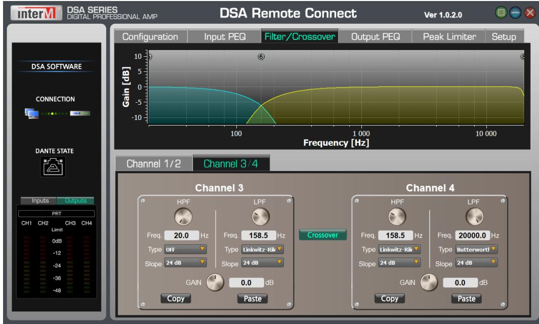
В режиме Bi-Amp настройки выходного параметрического эквалайзера, задержки и лимитера остаются несвязанными.
