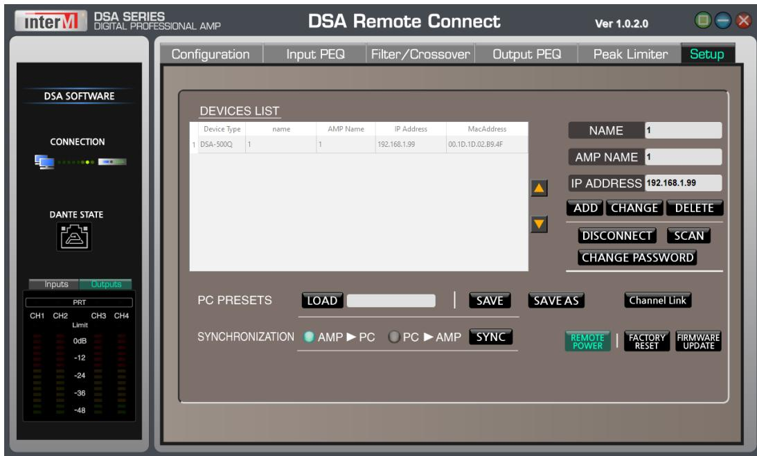
Функция PC PRESETS позволяет сохранять текущие настройки каналов выбранного усилителя и применять их для развертывания различных конфигураций систем звукоусиления.
