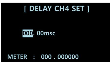
В разделе настройки линии задержки (DELAY) вы можете установить время задержки на каждом входном канале.
