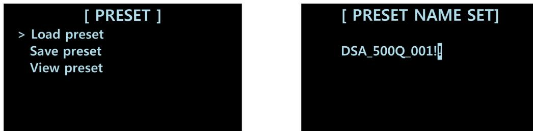
Настройки предустановок предлагают (PRESET) загрузку пресетов (LOAD PRESET), сохранение пресетов (SAVE PRESET), просмотр функций пресета (VIEW PRESET). Перед тем, как загрузить пресет, его следует создать. Сохранение пресета позволяет сохранить до 10 различных конфигураций каналов, включая эквалайзеры, задержку, усиление. Загруженные пресеты влияют только на выходные каналы.
