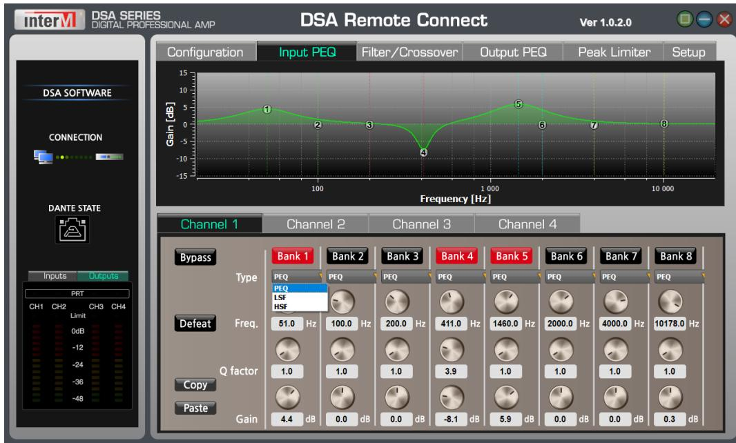
Для входа в настройки параметрического эквалайзера входных или выходных каналов нажмите на вкладку Input PEQ/Output PEQ. Управление параметрами фильтров доступно как с помощью графического интерфейса в верхней части окна, так и с помощью ручек-регуляторов в нижней части окна.
