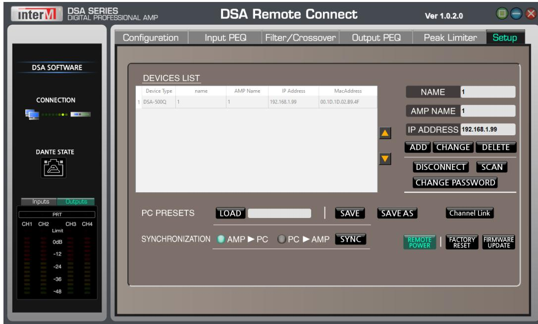
Функция Channel Link позволяет привязывать изменения настроек каналов или подключенных модулей к любым каналам.
