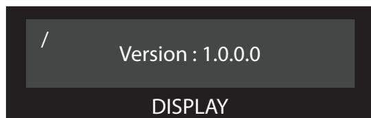
При повторном нажатии на кнопку MODE на дисплее отображается текущая версия программного обеспечения.
