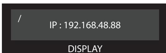
При однократном нажатии на кнопку MODE на дисплее отображается IP-адрес.
