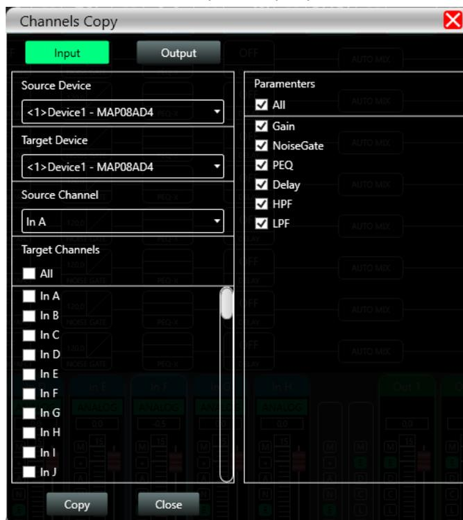
Как показано на рисунке выше, копирование канала заключается в том, чтобы сначала выбрать параметры канала исходного устройства и скопировать их в целевой канал других целевых устройств. Входной канал и выходной канал не могут копировать друг друга. Левая сторона — это соответствующий канал, а правая - скопированный параметр.
