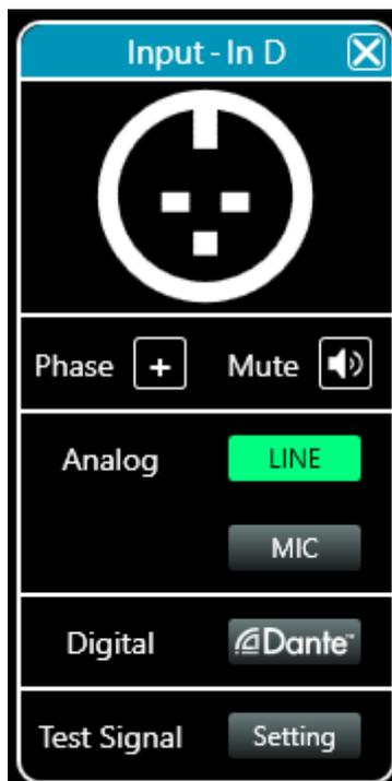
Как показано на рисунке, можно управлять полярностью, отключением звука и режимом входа соответствующего входного канала. В режиме входа - аналоговый вход, цифровой вход (опционально), и тестовый сигнал - три варианта, один канал может иметь только один режим входа.
