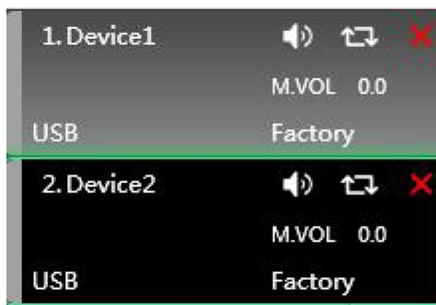
Кнопка отключения звука, кнопка обновления состояния, кнопка удаления устройства.
