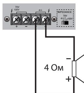
※ Устройство обеспечивает подключение как акустических систем общим сопротивлением 4 Ом, так и трансляционных громкоговорителей 70 В или 100 В. Не допускается одновременное использование нескольких вариантов подключения громкоговорителей.
