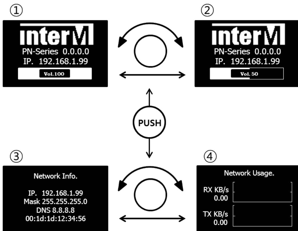
1. После включения и загрузки на ЖК-дисплее отображаются: название модели, версия ПО, IP-адрес устройства и уровень громкости выхода.
