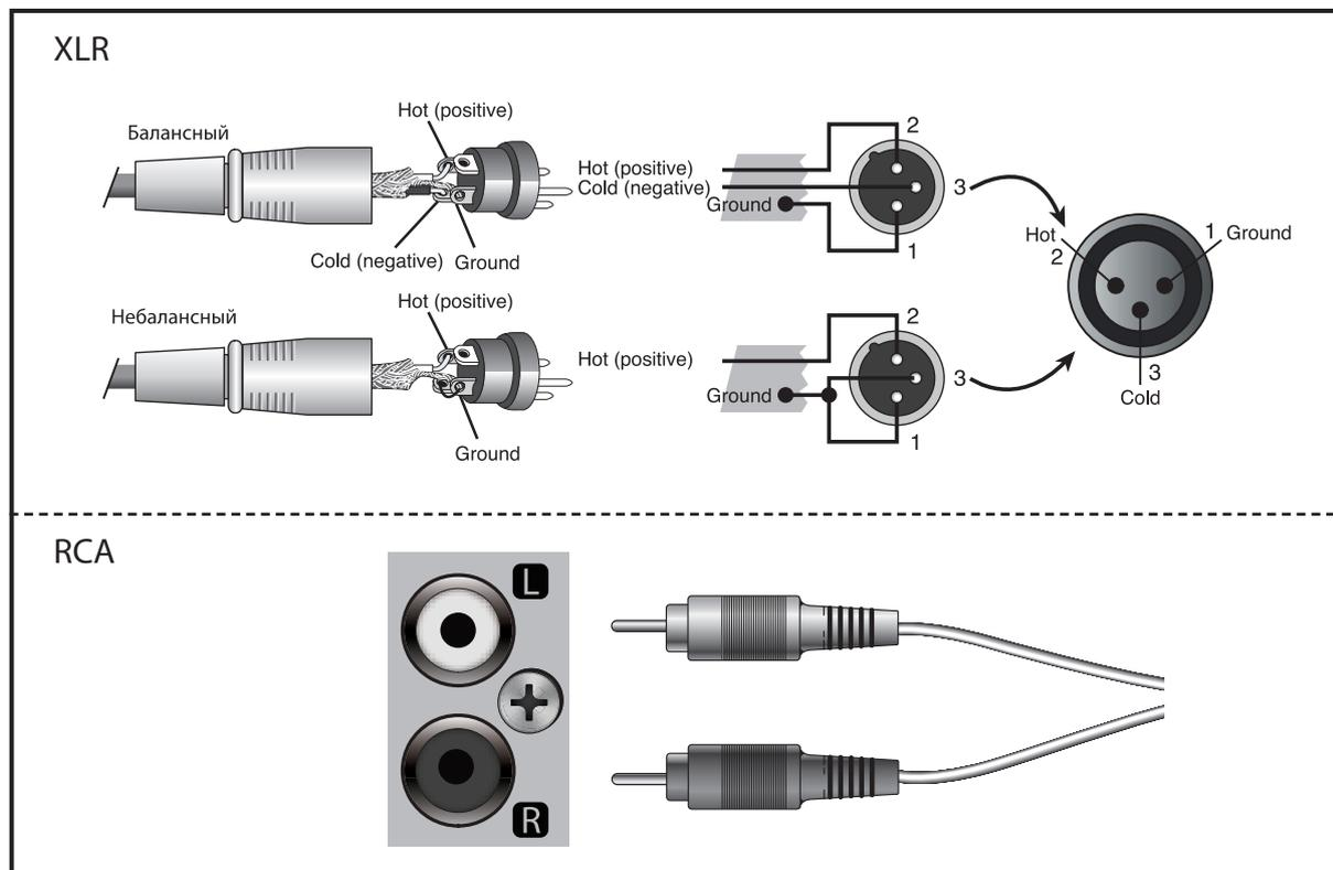
К входу INPUT 1 подключается кабель с разъемом XLR, к входу INPUT 2 - как кабель XLR, так и стереокабель с разъемами RCA.
