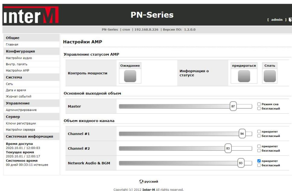
Регулировка громкости производится ползунком и позволяет установить уровень от 0 до 100 с дискретностью 1.
