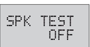
Находясь в режиме SPK TEST OFF, нажмите ◀◀ / ▶▶ для установки требуемого интервала от 1,5 до 720 минут. Кнопка ▶▶ служит для увеличения, кнопка ◀◀ - для уменьшения периода проверки.
