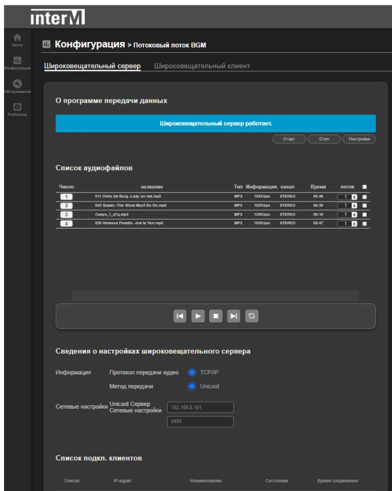
Метод передачи - Unicast и/или Multicast. Причем одноадресная и многоадресная передача могут осуществляться одновременно (одноадресная передача может передавать звук на 20 динамиков, а многоадресная передача - на 256 динамиков.)
