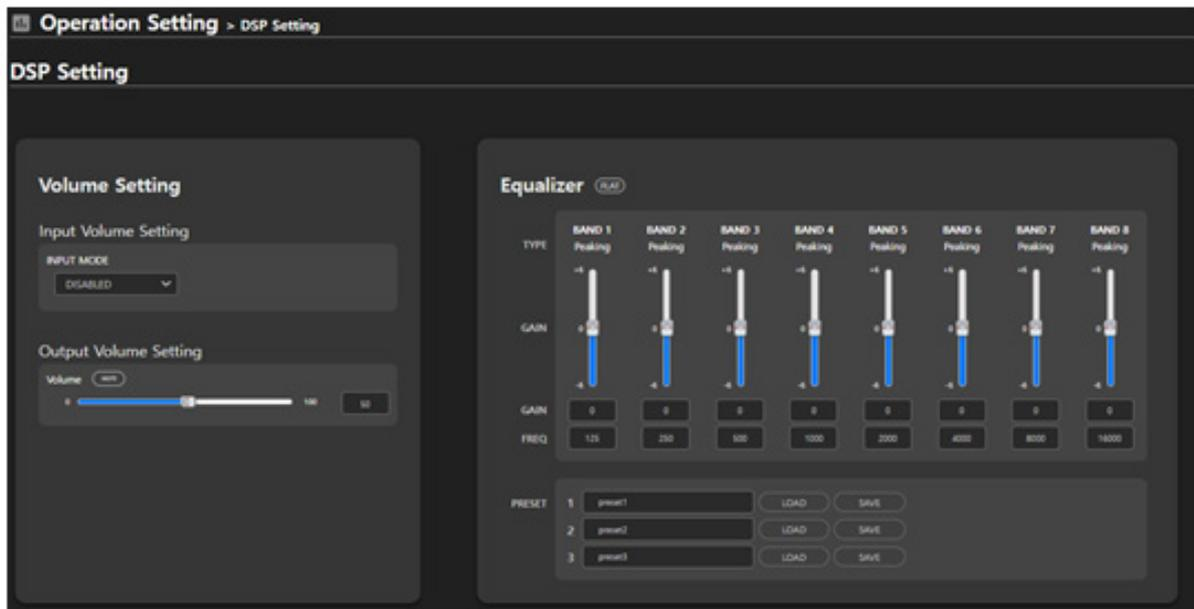
Регулировка частотных характеристик выходного сигнала присутствует только в WEB-интерфейсе IP-1015BX; но для IP-громкоговорителей IP-1015WS, IP-1015CS и IP-1015HS функция эквалайзера заблокирована, т.к. каждый из них имеет свои уникальные частотные характеристики и при их изготовлении частотные настройки учтены оптимальным образом.
