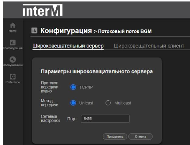
Данный режим можно организовать даже без назначения контроллера системы - достаточно двух IP-устройств (IP-спикеров или IP аудиомостов), из внутренней памяти одного из которых (сервера) воспроизводятся звуковые файлы, которые транслируются через сеть на выход клиента.
